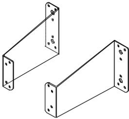
水平部材を取り付ける、中央部の2つのビス穴を5.5mmから6.5mmへ変更しました。ボルトで取り付ける場合はM6のボルトをご使用下さい。
